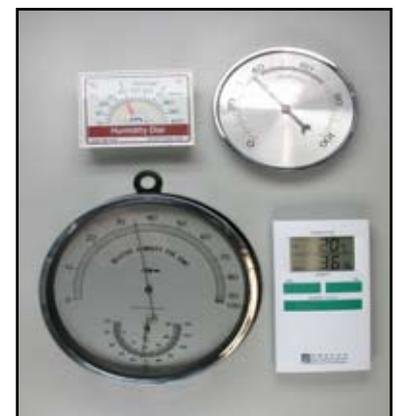
**Abbildung 17** Auswahl von mechanischen und elektronischen Hygrometern. (© RBGK)
