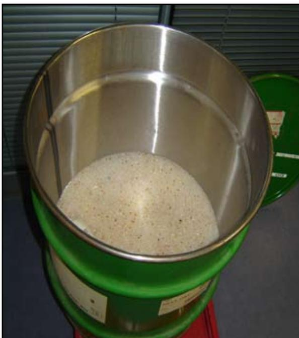
**Abbildung 13** Behälter zum Trocknen mit Silikagel. (© RBGK)
