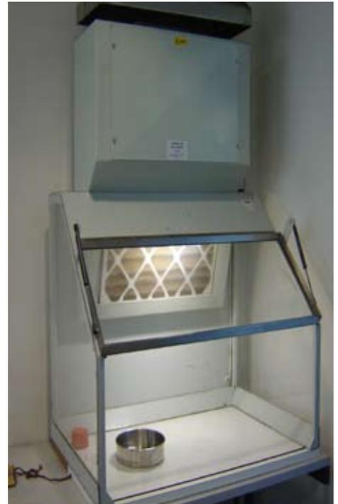
**Abbildung 6** Abzug für die Reinigung der Samen.
