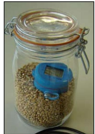
**Abbildung 16** Datenlogger zur Kontrolle der Gleichgewichtsfeuchte in einem abgedichteten Gefäß mit Saatgut. (© RBGK)
