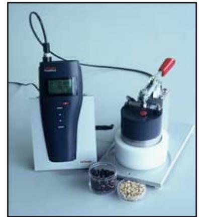
**Abbildung 15** Rotronic Hygrometer zur Messung der Gleichgewichtsfeuchte von Saatgutproben. (© Rotronic Instruments (UK) Ltd)
