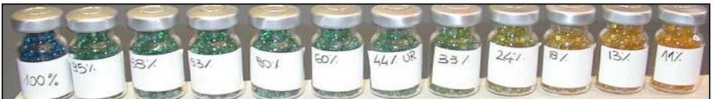
Abbildung 14 Feuchtigkeitsreihe von Silikagel von voller bis zu geringer Wassersättigung (von links nach rechts) (© MTSN)
